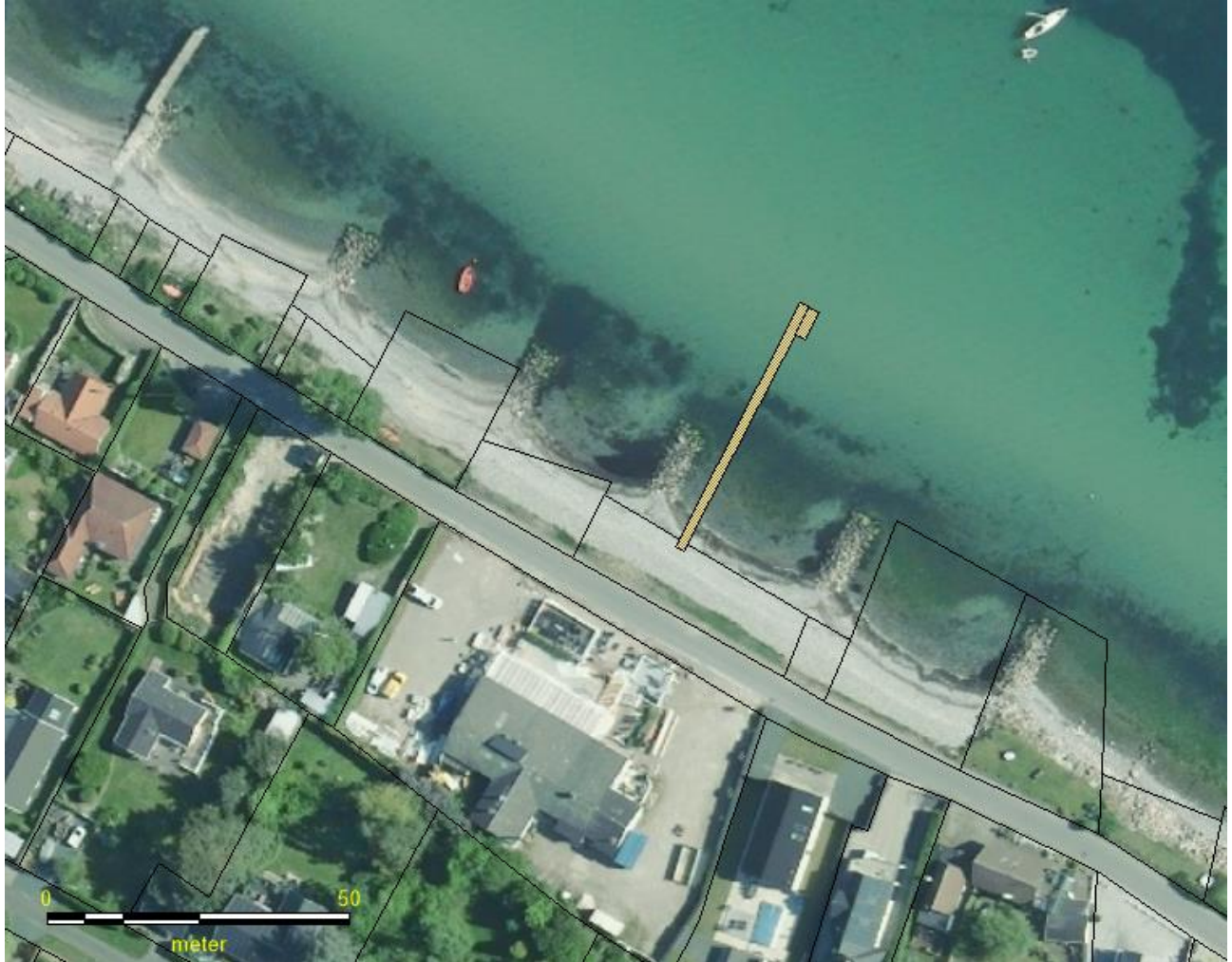
Luftfoto fra 2020 med skitse af 1,6 m bred badebro, 45 m lang og med en 3,5 bred platform de yderste 5 m.
