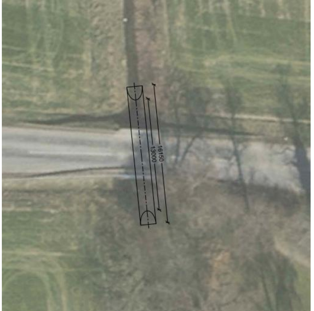
Figur 2. Det nye rør under broen bliver ca. 16 meter langt. Den eksisterende bro er ca. 8 meter.
