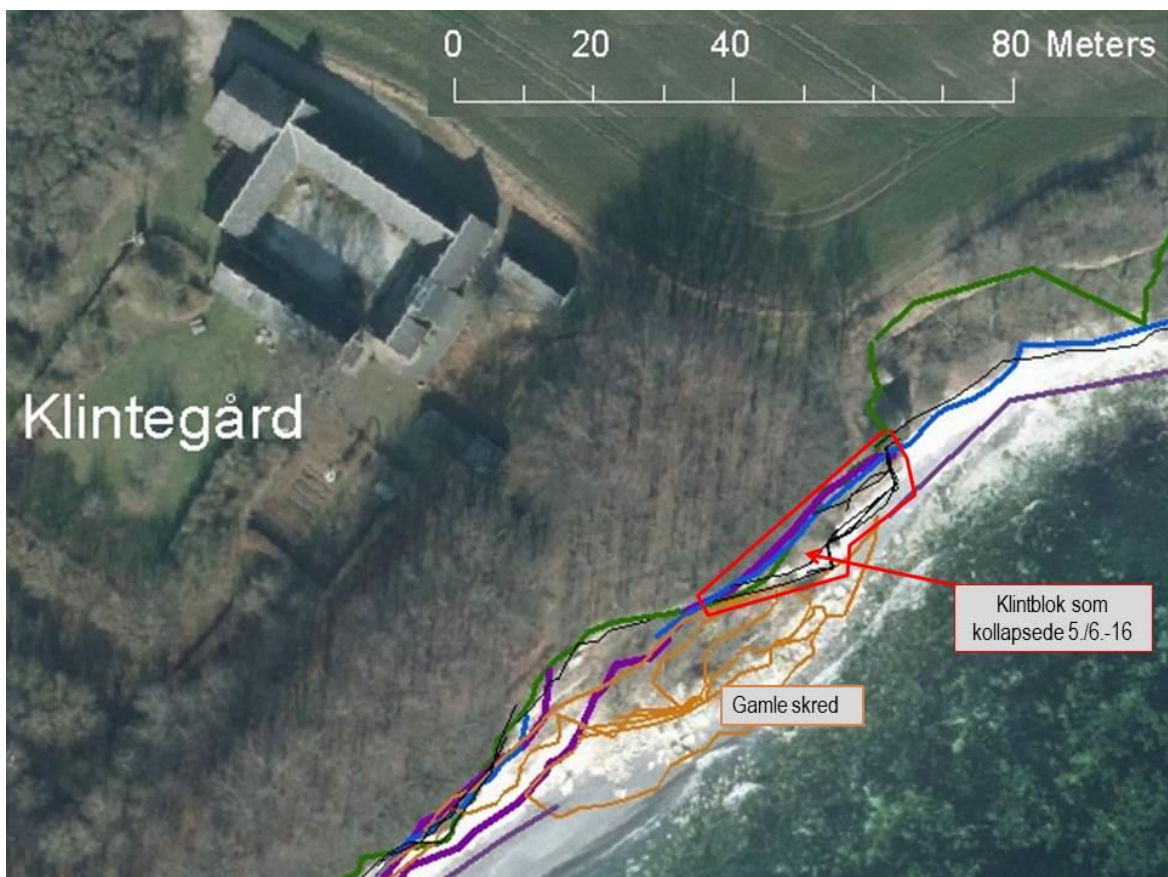
Figur 15. Et mere detaljeret udsnit af lodbilledet, som viser den kortlagte kalkbloks omrids. Bemærk at den blå streg angiver beliggenhed af kridtvæggen under overhænget. De sorte streger angiver bryozokalk væggen. Den grønne streg er toppen af klinten, mens de brune streger angiver skredkeglen dannet ved det gamle skred, som ifølge mundtlig overlevering skulle være sket for ca. 25 år siden.
